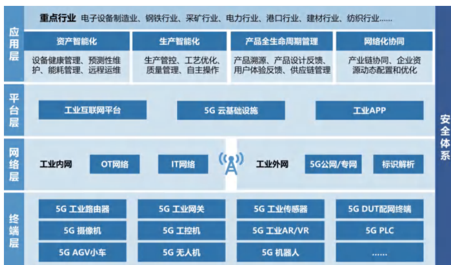
图 6：“5G+工业互联网”体系架构图
